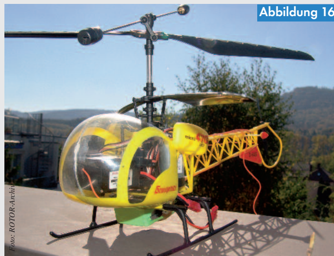
Die micro 47G von Graupner mit schräger Anordnung der Stabilisierungsstange am oberen Rotor.
